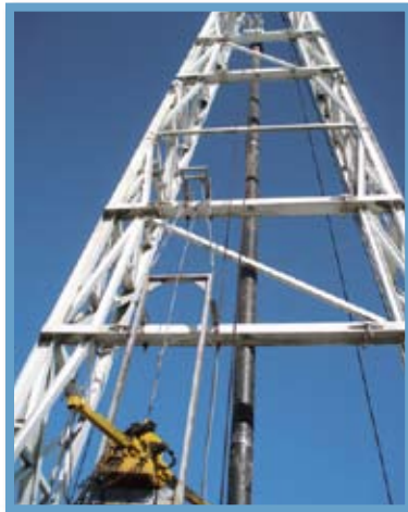
Triple-stand running 16" VAM® BOLT.
